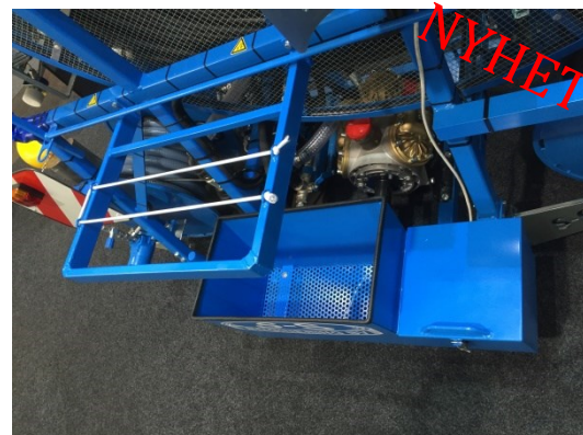
Transportkasse med låsbar del og stativ for lange redskaper
