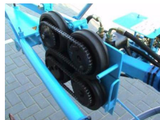
STANDARD: Firehjulstrekk med to seriekoblede oljemotorer!
