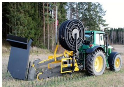
AFT KJEIDGRAVERE FOR DRENERING OG GRØFTEGRAVING
