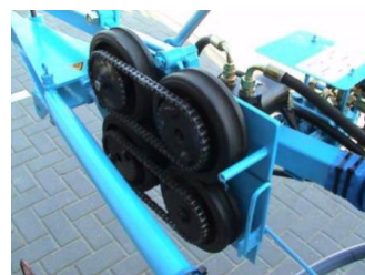
STANDARD: Firehjulstrekk med to seriekoblede oljemotorer!
